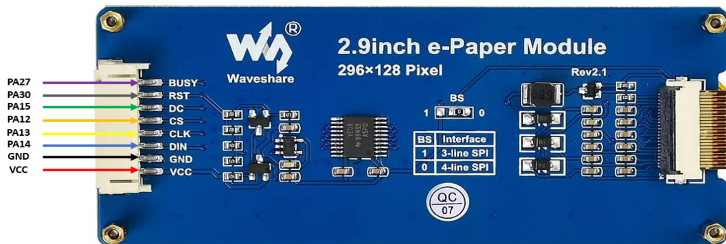
RTL8720DN(BW16) Wiring Diagram:
